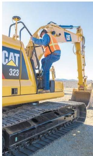
maintenance tout en augmentant la disponibilité et la rentabilité de la machine. Par exemple, sur la base d'un fonctionnement de 12 000 heures, le modèle Cat 320 utilisera 820 litres d'huile de moins et 50 filtres de moins que le modèle Cat 320F. Les points d'entretien quotidien des trois excavatrices sont accessibles au niveau du sol. Donc, les utilisateurs
